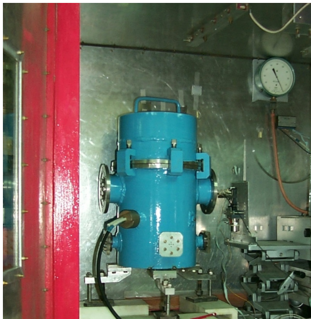
Рисунок 1.3 – Взрывная камера (15 грамм ВВ) на 5-ом канале ВЭПП-3 (17 ноября 1999 г.). В настоящее время станция демонтирована и не эксплуатируется.
