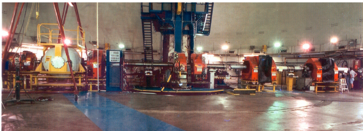
Рисунок 1.8 – Станция протонной радиографии динамических процессов. США, Лос-Аламос [52].
