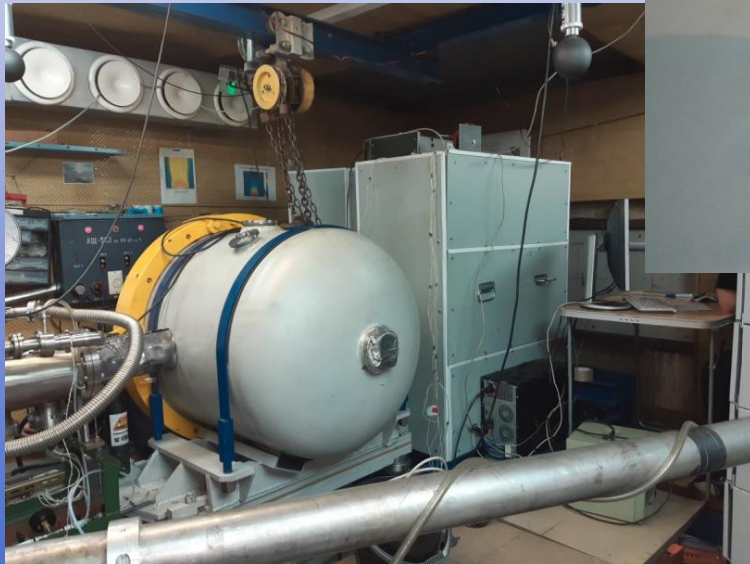
2019 г. Взрывная камера на 50 г. Время между кадрами 124 нс. E_{ef} = 20 кэВ.
