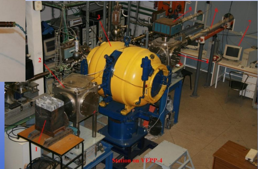
2013 г. Взрывная камера на 200 г. Время между кадрами 150-600 нс. E_{ef} = 40 кэВ.
